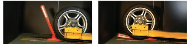
踏付けタイヤ荷重500kgの繰り返し踏付け試験にて、5000回実施後でも直立復元性に問題なし
