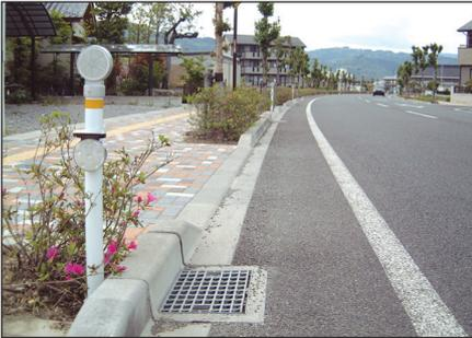
Φ100デリネーター支柱取付け (Φ60.5取付けバンド)
