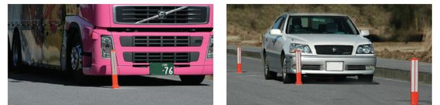
大型トラック(車重12t)ならびに乗用車(車重2t)による時速100km/hの衝突実験にて破損なし
