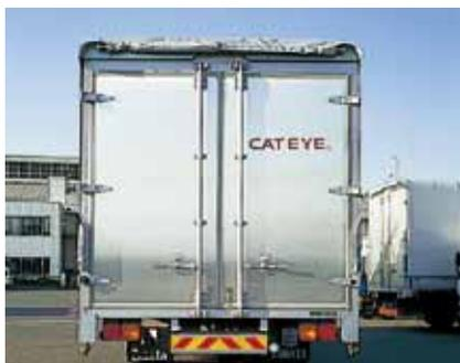
2011年9月1日以降の生産車両には「ECE R70」の技術要件を満たした大型後部反射器の装着が義務づけとなります。
