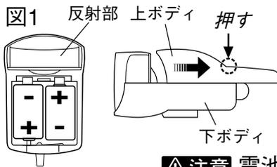
上ボディは三角のマークを押しながら、後側にスライドさせてはずします。(この時、パチッと音がします。)
