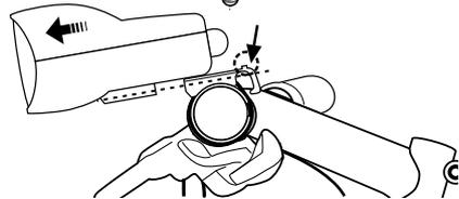
チット音がするまで差し込みます。はずす場合は、ブラケットの後にあるレバーを下げながら前方に引き抜きます。
