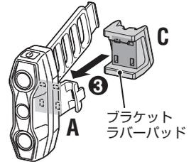
ブラケット (A) 裏面の凸部に合わせて、ブラケットラバーパッド (C) を取付けます。
