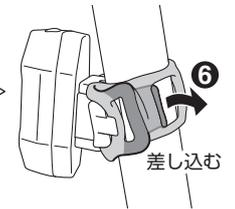
先端は隙間に差し込むことができます。
