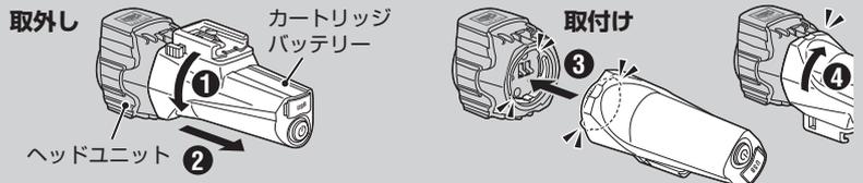
カートリッジバッテリーを反時計方向に回し、本体から取外します。
