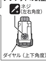
調整の際は、ブラケットが少し動く程度にダイヤルやネジを緩めてから調整し、最後にしっかり締付け固定します。
