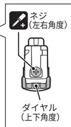
※再調整の際は、ブラケットが少し動く程度にダイヤルやネジを緩めてから調整し、最後にしっかり締付け固定します。
