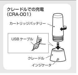
を USB ケーブルで接続します。 **①**~**②** スイッチもしくはクレードルのインジケー 夕が点灯して充電が始まります。
