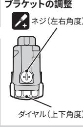
※ 調整の際は、ブラケットが少し動く程度にダイヤルやネジを緩めてから調整し、最後にしっかりと締付け固定します。
