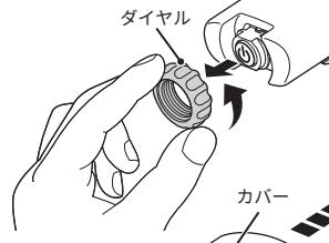
② レンズボディをカバーから引抜き、+ - を合わせて乾電池を挿入する
