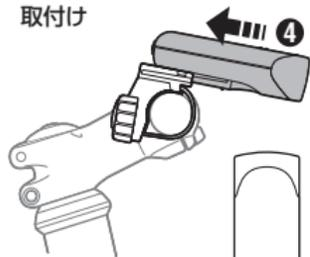
ライト本体をブラケットにカチッと音がするまで差込み、照射角度を調整します。④
