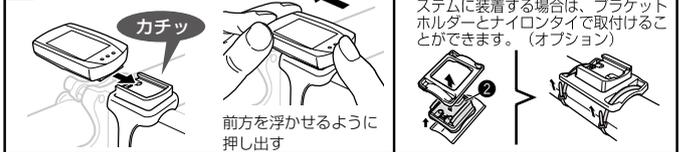
※ 取付後、前輪を軽く回し、コンピュータに速度が表示されることを確認します。表示されないときはA、B、Cの位置関係が正しいか確認してください。
