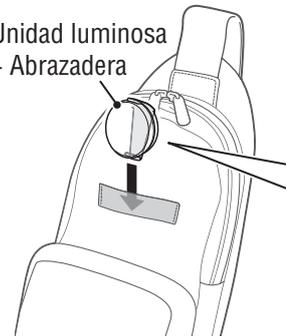
Retirada/instalación de la Abrazadera
