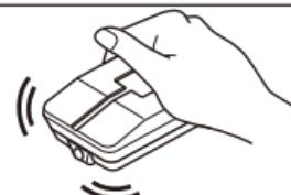
在亮處如需確認自動感應模式是否啟動和發光模式時，請用手遮住按鈕相反方向「亮度感應器」處，並給以振動。
