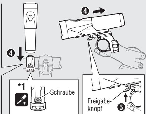
1. Montieren Sie die Halterung am Lenker. (1 – 3)
