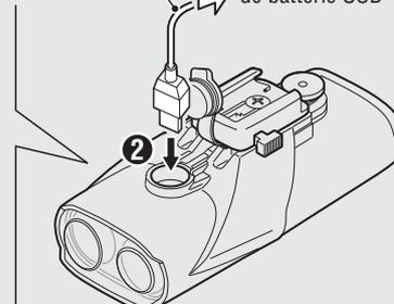
1. Branchez le bloc d'éclairage sur votre PC ou sur un chargeur de batterie USB du commerce en utilisant le câble USB. (1 – 2). Le bouton s'allume et le chargement commence.
