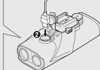
1. Conecte la unidad luminosa a su PC o a un cargador de batería USB disponible en el mercado mediante el cable USB. (1 – 2). El conmutador se ilumina y la carga se inicia.
