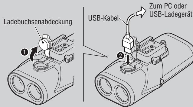
1. Verbinden Sie die Lampeneinheit über das USB-Kabel mit Ihrem PC oder einem handelsüblichen USB-Akkuladegerät. (1 – 2). Der Schalter leuchtet auf, der Akku wird geladen.
