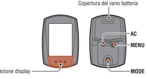
Dopo l'installazione, controllare che venga visualizzata la velocità quando si ruota leggermente la ruota posteriore, mentre la cadenza viene visualizzata quando si ruota la manovella. Quando non viene visualizzato, controllare di nuovo le condizioni di installazione A e B (a pagina 2).
