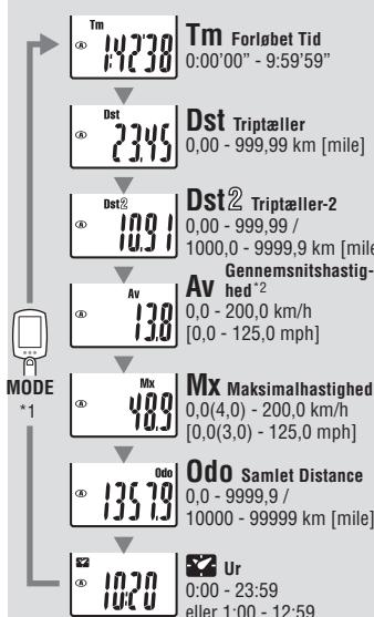
\*1 Med computeren monteret på beslaget trykker du på de tre hævede prikker på computerens forside.
