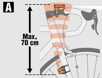
La distancia entre la computadora y el sensor se encuentra dentro de la longitud de transmisión de datos y la parte posterior de dicha computadora está orientada hacia abajo.
