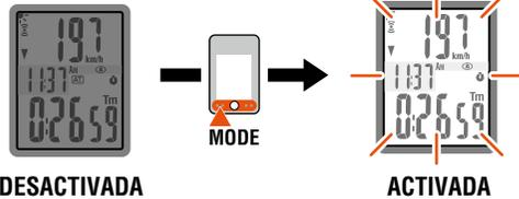
**Método de configuración** Si mantiene pulsado el botón **MODE** pasará a establecer del modo Noche. Si mantiene pulsado el botón de nuevo se activará el modo Noche y volver a la pantalla de mediciones.
