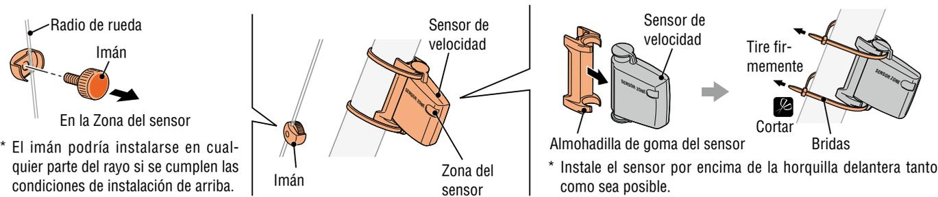
\* El imán podría instalarse en cualquier parte del rayo si se cumplen las condiciones de instalación de arriba.
