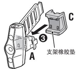
将支架橡胶垫 (C) 安装到尾灯固定座 (A) 背面。
