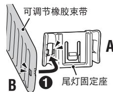
将可调节橡胶束带 (B) 安装在尾灯固定座 (A) 上。
