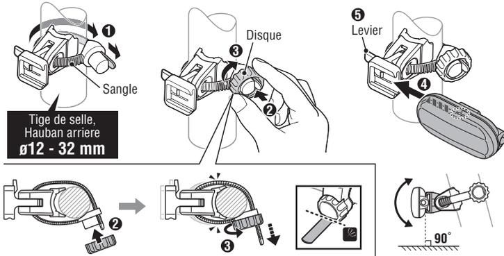
1. Fixez le support sur le socle du siège ou la barre du siège comme indiqué. (1 - 3)
