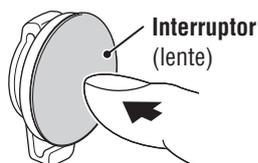
Los modos ENCENDER/APAGAR y de iluminación se seleccionan mediante un conmutador.
