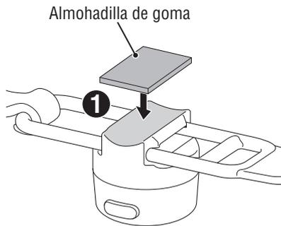
Acoplar de forma segura en la posición de instalación.
