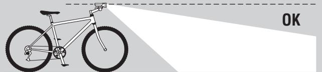
Achten Sie bei der Montage der Leuchteinheit darauf, dass das Licht andere Verkehrsteilnehmer nicht blendet. Passen Sie den Winkel an, indem Sie den Verschlussring oder die Schraube (\*3) so weit lösen, dass sich die Halterung geringfügig bewegt. Nehmen Sie die Anpassung vor und ziehen Sie beides zur Fixierung der Leuchteinheit wieder an.
