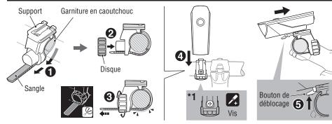
\*1: Vérifiez régulièrement le disque et la vis (\*1) sur le support, et ne les utilisez que s'ils sont bien serrés.
