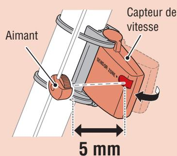
\* L'aimant peut être installé dans n'importe quelle position sur les rayons tant que les conditions d'installation sont respectées.
