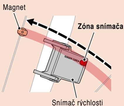
**!** Vzďialenosť medzi snímačom rýchlosti a magnetom je v rozmedzí 5 mm.
