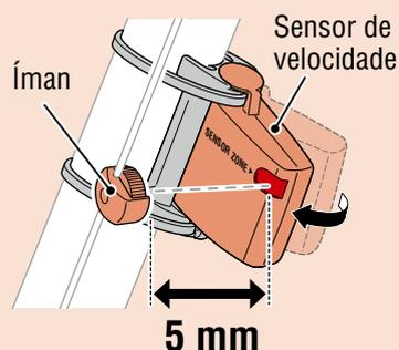
\* O íman pode ser montado em qualquer posição no raio desde que as condições de fixação sejam cumpridas.
