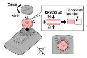
3. Después de cambiar la batería, presione AC en la parte posterior del computador. (Operación de reinicio)
