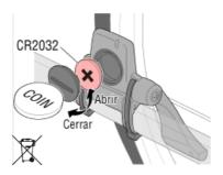
\* Después de cambiar la batería, pulse siempre **RESET** y compruebe la posición del sensor con respecto al imán.
