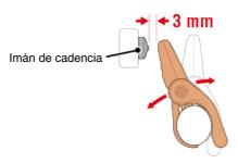
(2) Gire el brazo del sensor de forma que quede aproximadamente 3 mm entre el imán de la rueda y la zona del sensor de velocidad; a continuación, apriete el tornillo del sensor de forma segura.
