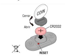
\* Después de reemplazar la batería, presione siempre **RESET**.
