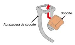
2. Elimine el sello de la junta de caucho del soporte y fíjela en la abrazadera de soporte.
