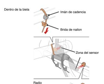
(1) Con una brida de nailon, fije el imán de cadencia provisionalmente al interior de la biela izquierda de forma que quede orientado hacia la zona del sensor de cadencia.
