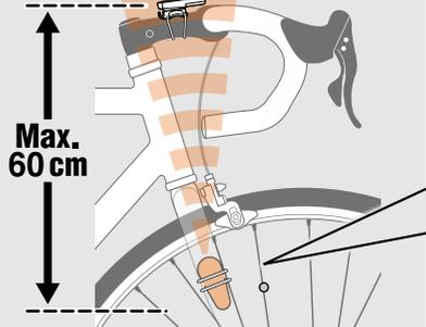
**B** Der Magnet muss die Sensorzone durchlaufen.
