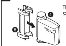
\* Installate il sensore il più vicino possibile alla parte superiore della forcella anteriore.
