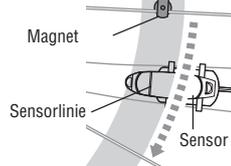
**B** Der Abstand zwischen der Sensoroberfläche und dem Magneten darf nicht mehr als 3 mm betragen.
