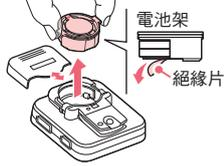
拉起任一固定片時電池架會浮起。請抽出電池下方的絕緣片。
