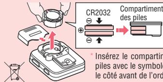
\* Insérez le compartiment des piles avec le symbole vers le côté avant de l'ordinateur.
