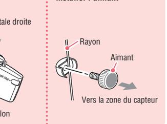
Lorsque vous avez installé le capteur de vitesse, vérifiez que la vitesse s'affiche sur l'ordinateur en faisant tourner la roue avant avec l'ordinateur installé dans le support. Si elle ne s'affiche pas, vérifiez les conditions d'installation et vérifiez les positions du capteur de vitesse et de l'aimant.
