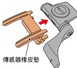
(3) 按照圖示使用尼龍束帶將傳感器暫時安裝於左後下叉。
