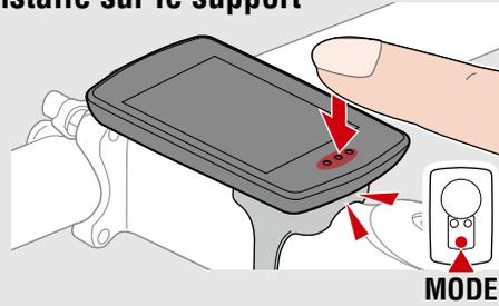
Lorsque le compteur est monté sur le support, appuyez une fois sur la zone pointillée du compteur pour baisser le bouton **MODE**.
