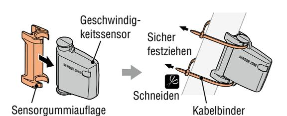
\* Installieren Sie den Sensor möglichst hoch an der Vorderradgabel.
