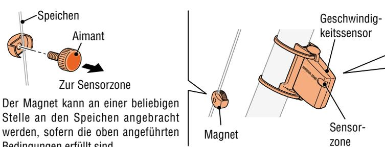
\* Der Magnet kann an einer beliebigen Stelle an den Speichen angebracht werden, sofern die oben angeführten Bedingungen erfüllt sind.
