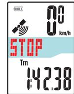
\* Les données du début de la mesure jusqu'à l'opération de réinitialisation sont enregistrées comme un seul trajet, que l'appareil soit allumé ou éteint. Pour continuer la mesure, coupez l'alimentation sans effectuer d'opération de réinitialisation. Pour plus de détails, référez-vous à la section "Remettre à zéro les données de mesure et pour générer les données de trajet" (page 18).
