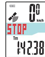
\* Los datos a partir del momento en el que se inicia la medición hasta la operación de restablecimiento, se graban como un solo recorrido, independientemente de si la unidad está encendida o apagada. Para continuar con la medición, desconecte la alimentación sin realizar una operación de restablecimiento. Para obtener detalles, consulte la sección “Restablecer los datos de medición y generar los datos del trayecto” (página 18).
