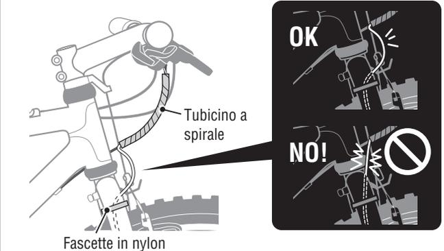
Fissare il cavo sulla forcella con le fascette in nylon e portare il supporto al manubrio lungo la guaina freno legandolo tramite il tubo a spirale.
