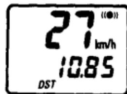
Die Momentangeschwindigkeit wird in der oberen Zeile des Bildschirms angezeigt und ändert sich mit jeder Sekunde zwischen 0(4) bis 105 km/h). Die Obergrenze der meßbaren Geschwindigkeit hängt von der Radgröße lt. nachstehender Tabelle ab.
