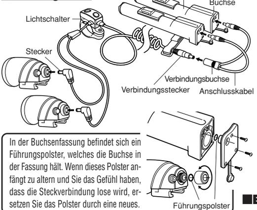
In der Buchsenfassung befindet sich ein Führungspolster, welches die Buchse in der Fassung hält. Wenn dieses Polster anfängt zu altern und Sie das Gefühl haben, dass die Steckverbindung lose wird, ersetzen Sie das Polster durch eine neues.
