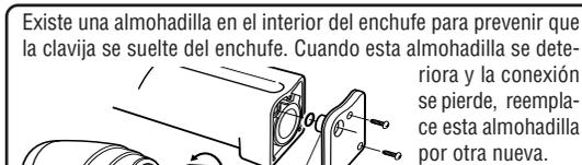
Existe una almohadilla en el interior del enchufe para prevenir que la clavija se suelte del enchufe. Cuando esta almohadilla se deteriora y la conexión se pierde, reemplácela por otra nueva.
