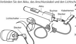
· Befestigen Sie das Kabel mit Kabelband so entlang dem Rahmen, dass es sie nicht beim Fahren behindert.
