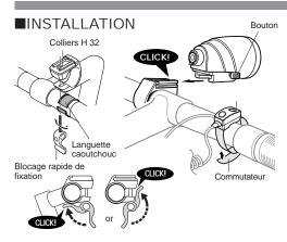
Fixez le collier H 32 sur le cintre. Bloquez le collier au moyen du blocage rapide. Glissez l'éclairage sur le support jusqu'au click d'enclenchement.
