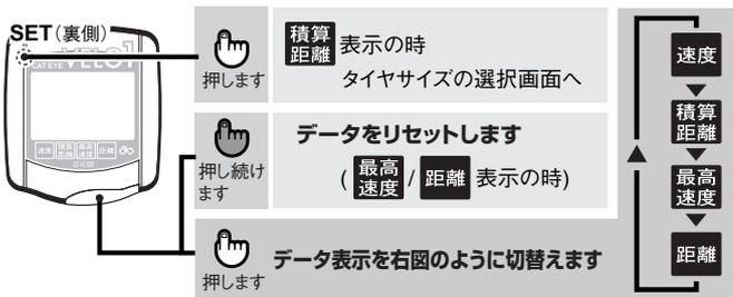
自転車が走り出すと自動的に計測を開始し、止まると計測を停止します。
