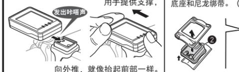
安装之后，慢慢旋转前轮，检查码表上显示的速度。如果没有显示，检查位置A、B和C。
