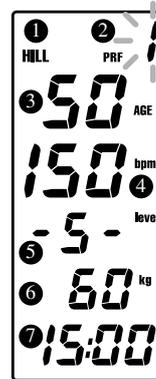
補足:数字画面のデータはこの状態の時、自由に変更できます。十一ボタンを押すと点滅している数字が増減します。またMODEボタンを押すと点滅する数字の位置が移動します。が、今は機械になれていただくのが目的ですので、もし数字を変えたら元に戻してください。
