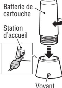
1. Branchez le bloc d'éclairage sur votre PC ou sur un chargeur de batterie USB du commerce en utilisant le câble USB. (1 - 2). L'interrupteur ou le voyant de la station d'accueil s'illuminent, et la charge commence.
